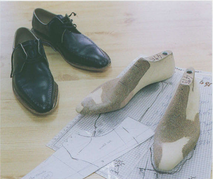
ビスポークの靴づくりは、こうして木製ラストを修整し、パターンを起こして、トライアルをつくる。採寸はローリング氏が行うという。
