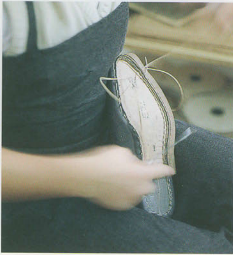
ウェルティンはプレタポルテもビスポークも、全てハンドソーンにて行う。糸は意外にもナイロン製。ローリング氏の検討の結果だ。
