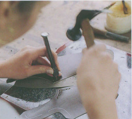
工程には、熟練した手作業が随所に見られる。パンチングの穴を開ける工程もハンドで行っている。ほとんど下描きなどせず、見当ですばやく穴を開けていく。
