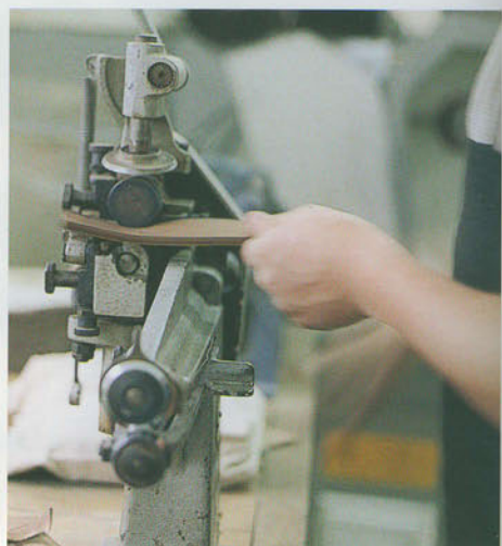
これもまた丁寧な作業の一例。ローラーでインソールの部材に圧を加えている。こうすることでより密度が高まり、剛性が上がる。
