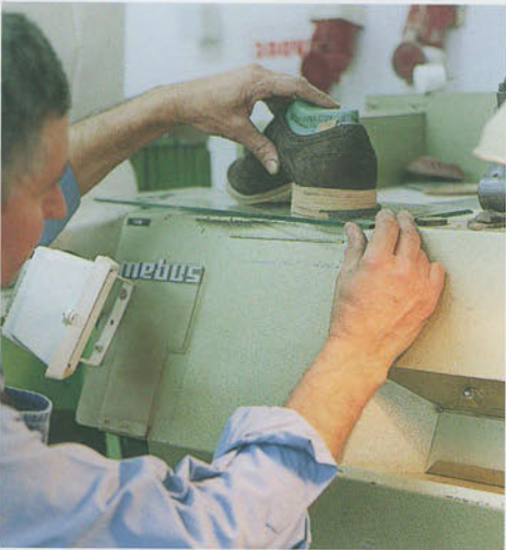
サン クリスピンでは、ヒールはすべて一足一足積み上げてつくる。平らなガラスに乗せそのバランスを見る職人。
