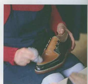
仕上げのポリッシングは、手間のかかる仕事。1時間の作業の効率化と美しい仕上げのため独自の配合のワックスを用いている。
