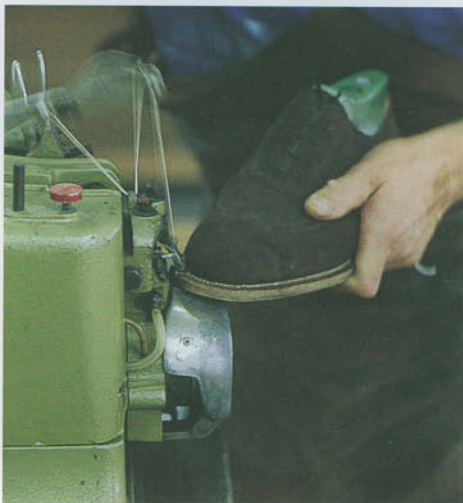
1950年代のものという、底づけのマシン。ガイドが穴を開けた後に針で糸を通す仕組み。この機械の使用が、ペイスとの併用を生んだ。
