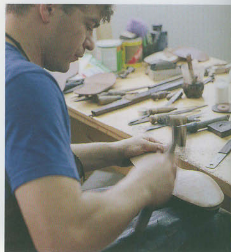
ソールをならすためにハンマーで叩く。サン クリスピンの場合、ウエスト部の底づけはペイスを使ったものになる。
